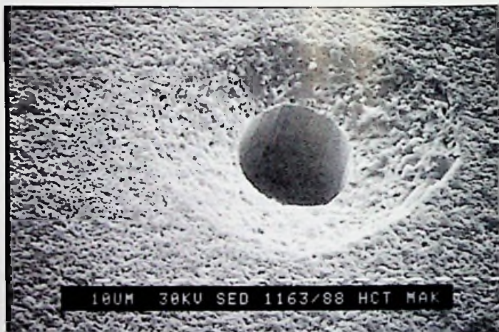
Figuur 3 De oppervlaktekwaliteit van de wand van een gat dat geboord is met een excimeerlaser is zeer goed, zoals blijkt uit dit voorbeeld van een gat van 90 µm in keramisch materiaal.
