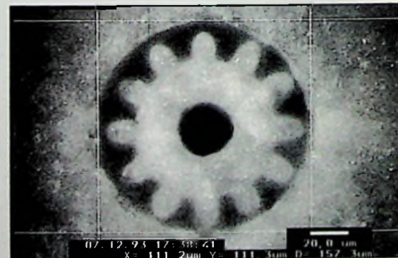
Figuur 18 Keramisch micro-tandwiel, vervaardigd door ablatie met een excimeerlaser
