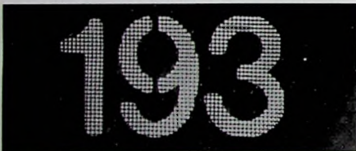
Figuur 15 Met de excimeerlaser aangebrachte markering in glas
