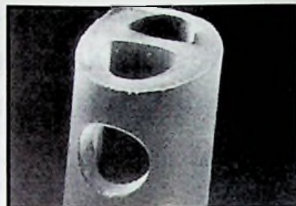
Figuur 2 Gat met een diameter van 0,5 mm door een excimeerlaser geboord in een kunststof catheter voor het meten van het zuurstofgehalte in bloed
