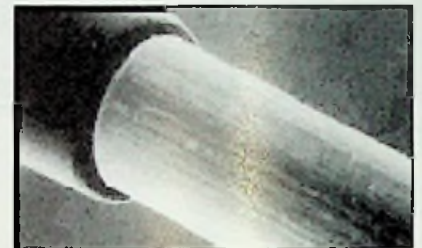
Figuur 17 Een 50 mm dikke koperdraad waarvan de isolatie d.m.v. ablatie wordt verwijderd
